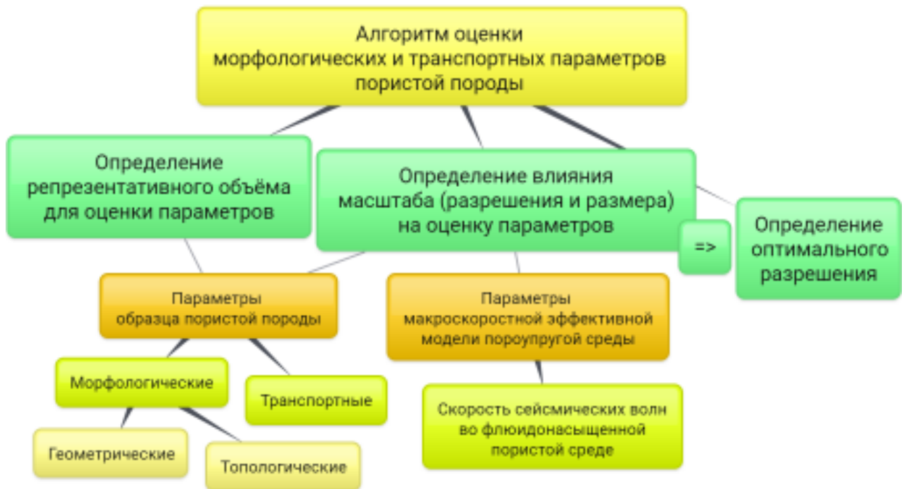
Рисунок 2.1 – Схема алгоритма оценки морфологических и транспортных параметров по томографическим изображениям образца горной породы
