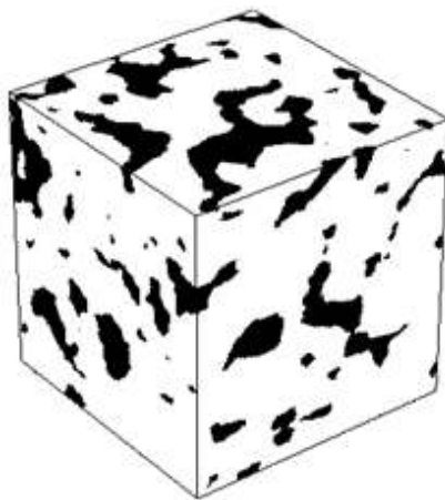
Рисунок 3.22 – Трёхмерная бинарная модель образца песчаника обнажения Берсиммер (Австралия). Скелет - белым цветом, поры - черным
