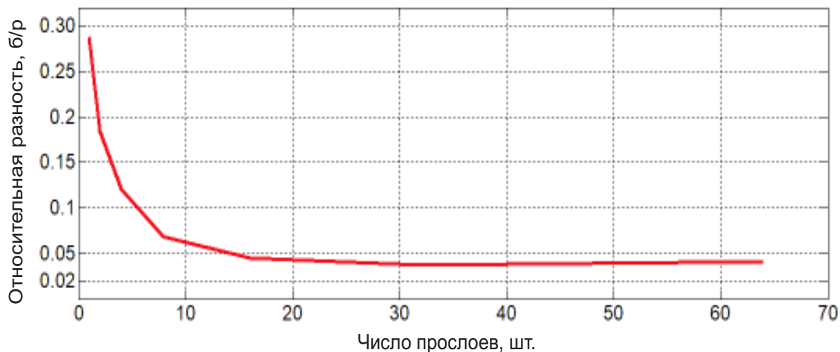
Рисунок 3.18 – Уменьшение относительной разности значений эффективного тензора жёсткости при увеличении количества прослоев в трёхмерной модели породы с наклонной под углом 45^\circ слоистостью
