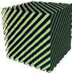
Рисунок 3.19 – Трёхмерная модель породы с наклонным под углом 45^\circ падением слоев по двум разным направлениям
